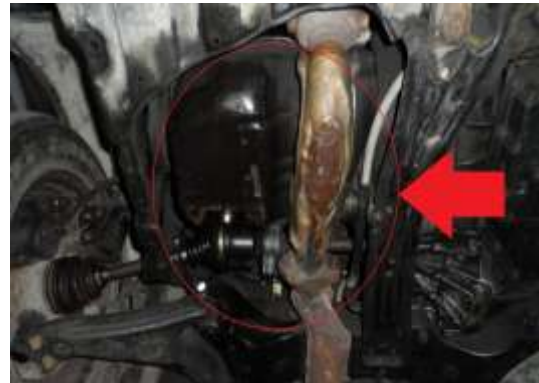
(圖3-17)將管路遷至機油殼與 排氣管端
