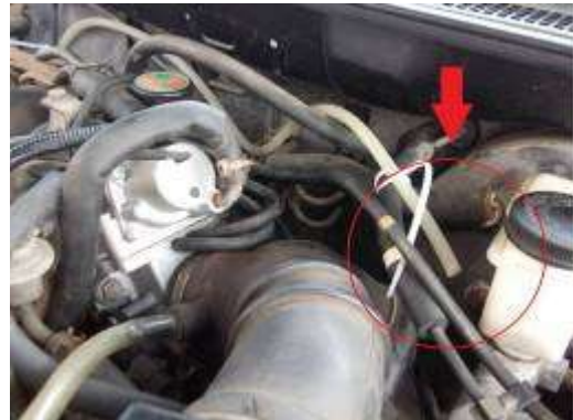
(圖3-15)將管路遷至剎車總泵
