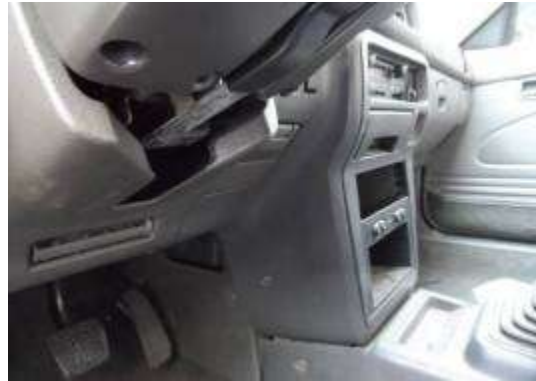
(圖4-6) 架設滅火器鋼索到車內拉柄
