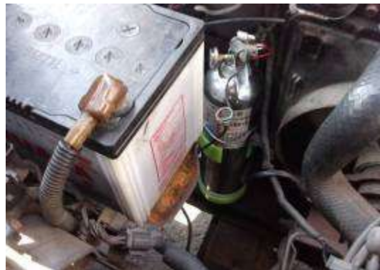
(圖4-4) 架設滅火器
