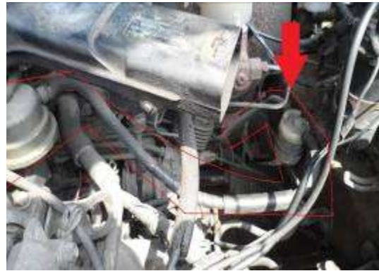
(圖 3-1)汽油管洩漏會與電瓶搭鐵產生起火燃燒
