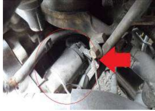
(圖 3-6) 啟動馬達電洩漏易造成起火燃燒
