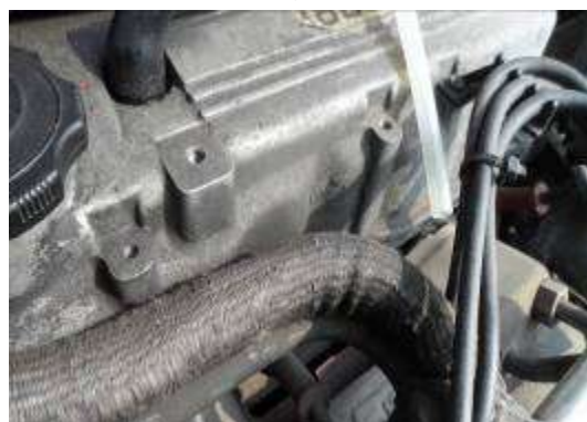
(圖4-12) 將管線導引至各起火點(三)
