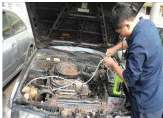
(圖4-9) 將管線長結合滅火器並牽管
