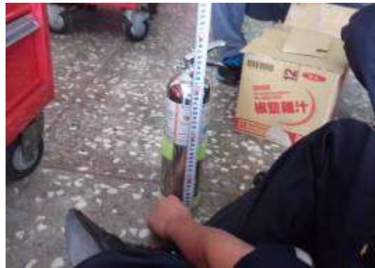
(圖4-3) 量測滅火器尺寸與空間的搭配
