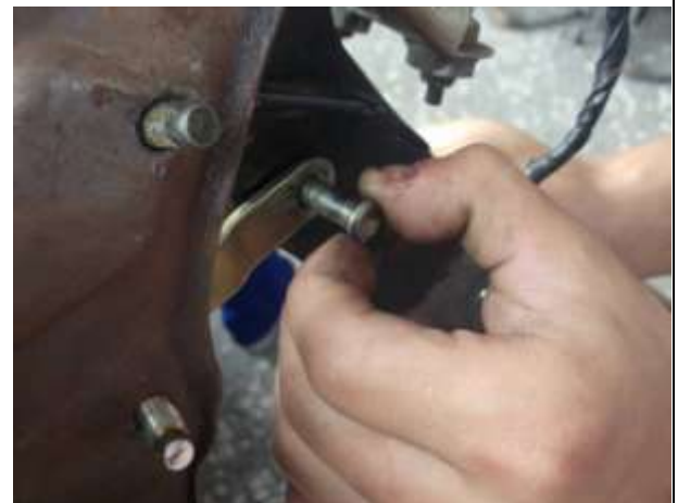
圖19 將倍力氣推桿及踏板插銷裝回
