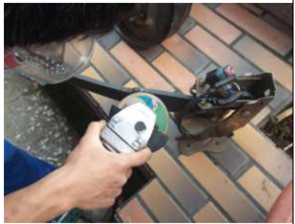
圖13 將焊接部位磨平
