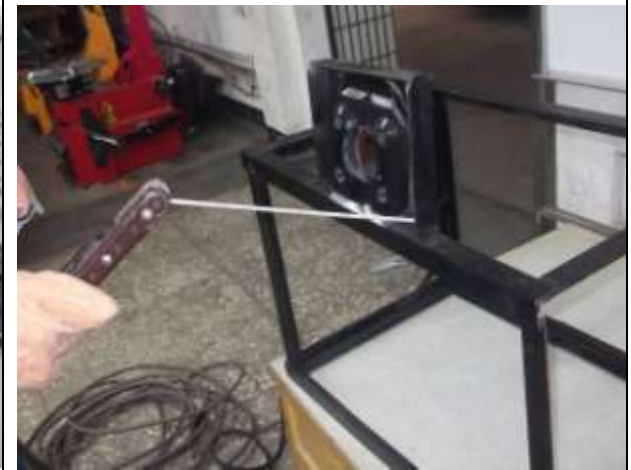
圖11 焊接真空被力器固定支架
