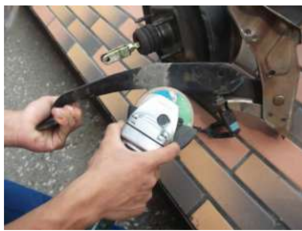
圖14 將焊接部位磨平後
