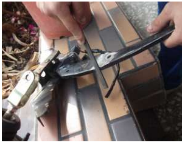
圖16 將磨平部分拋光完成
