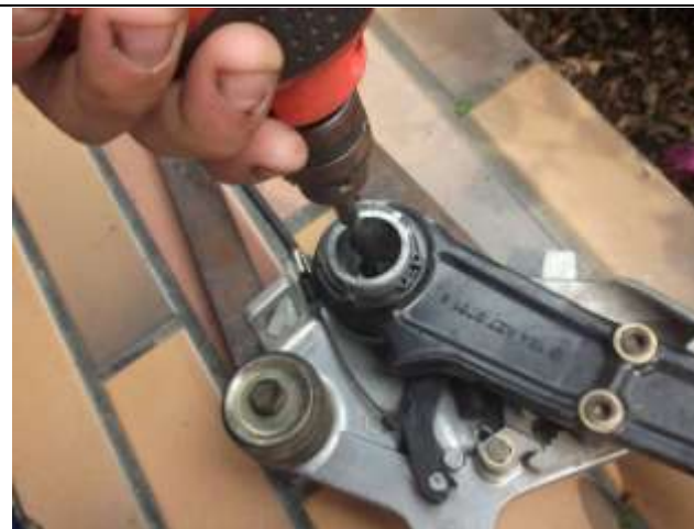
圖6 先將固定位置鑽出
