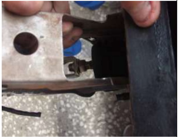
圖17 將煞車踏板和真空倍力氣組裝
