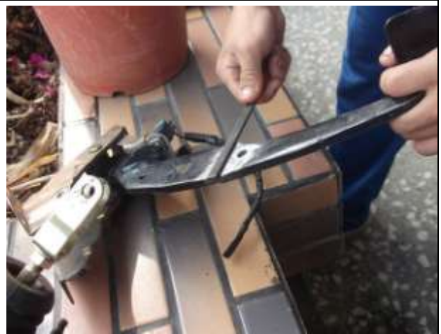
圖15 將磨平後部位用銼刀拋光
