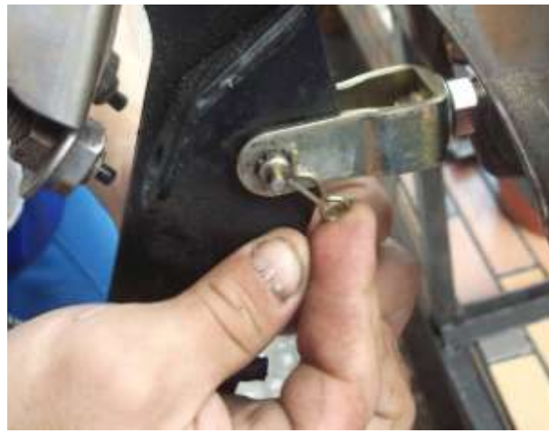
圖20 插入插銷後將固定銷插回
