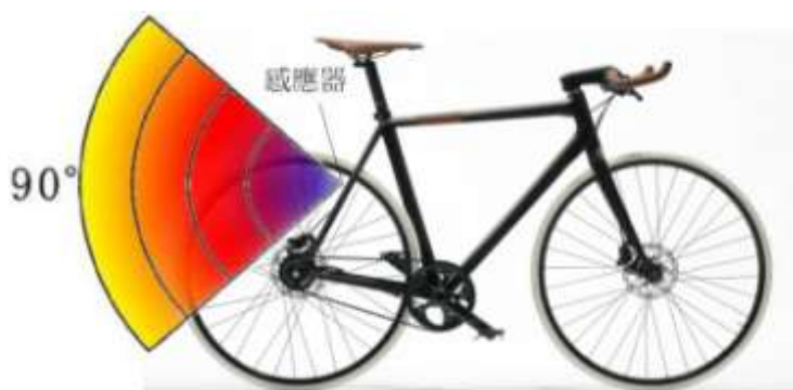
(圖二) 倒車雷達有效感應距離
