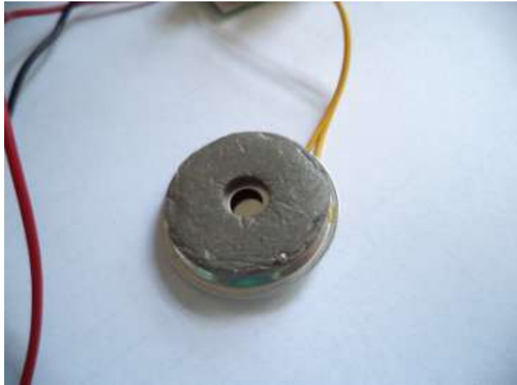
圖 4 蜂鳴器內部構造圖 (資料來源：自行拍攝)
