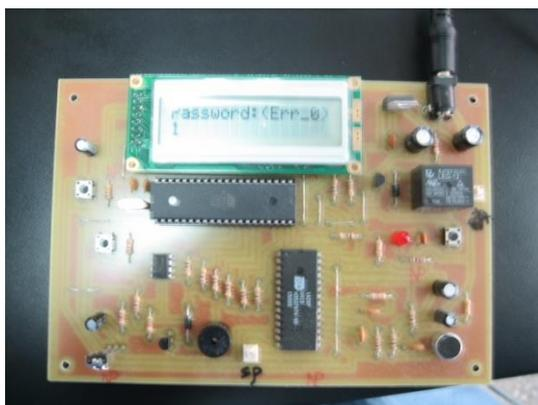
圖 4-1-6 電子密碼鎖電路板成品圖
