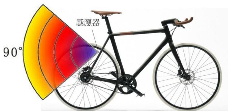
(圖二) 倒車雷達有效感應距離
