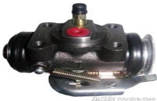
圖 5 煞車分泵（鼓式）
