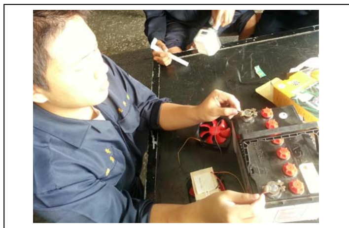
圖14. 通電測試致冷晶片作動
