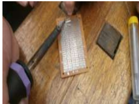
（圖 3-1）銲接電路板
