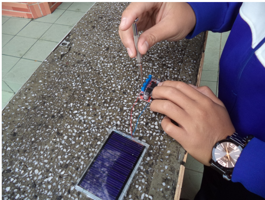
圖12 充電模組調整電壓製作(二)
