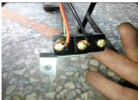
串聯接出來的兩條線路連接到微動開關做感應裝置 (圖6)電線連接微動開關圖
