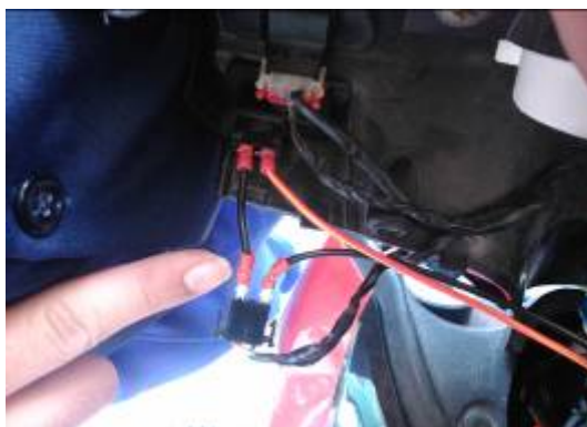
從啟動馬達線路連接出兩條線路做串聯 (圖5)改變啟動馬達線路圖
