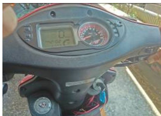
這張圖是機車邊柱沒有碰觸到微動開關 (圖8)邊柱無碰觸微動開關圖
