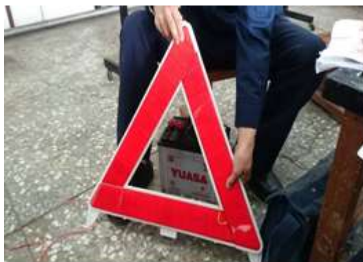
圖 10 將所有反光片裝上三角板
