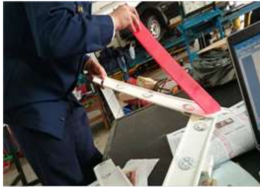
圖 8 將反光片裝上三角板
