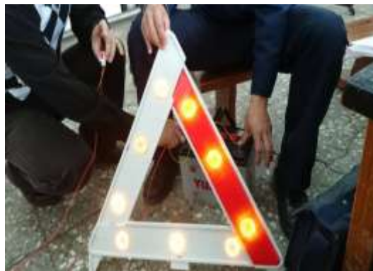
圖 9 測試裝上反光片後的效果
