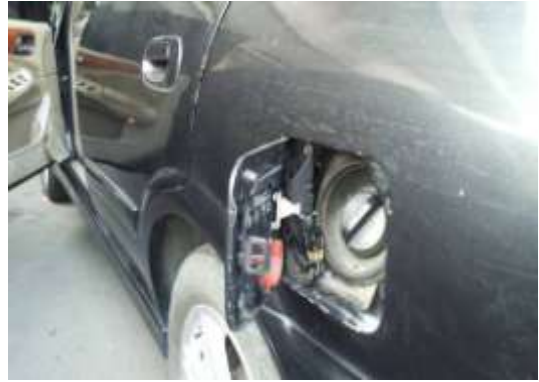
圖2-7 排到R檔後將油箱蓋打開
