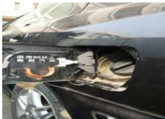
圖 1-6 油箱蓋線路安裝
