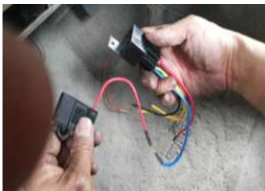
圖 1-3 外接噴油嘴保險絲座和繼電器開關
