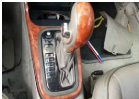
圖2-6 將檔位排至D或R檔進行測試
