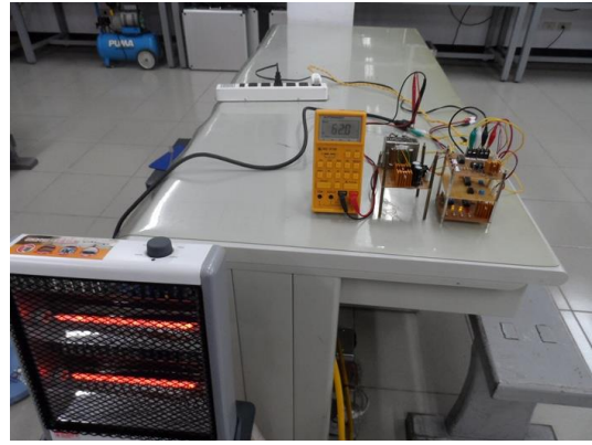
圖 29 左側發射端電位計滿刻度之四分之三時，右側是無線接收端之主電路的運作情形，交流輸出電壓 62V。
