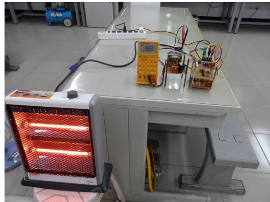
圖 28 左側發射端電位計滿刻度之四分之二時，右側是無線接收端之主電路的運作情形，交流輸出電壓 92.3V。
