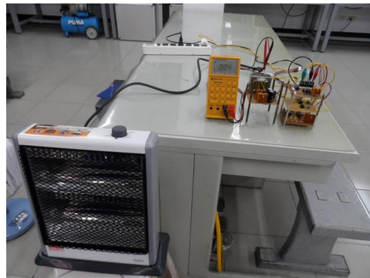
圖 30 左側發射端電位計滿刻度時，右側是無線接收端之主電路的運作情形，交流輸出電壓 0V。
