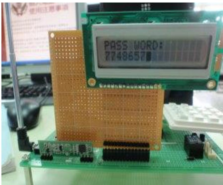
圖 4-1-4 密碼鎖之 LCD16 數字顯示器
