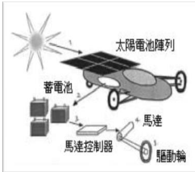
(圖二) 太陽能車作動原理
